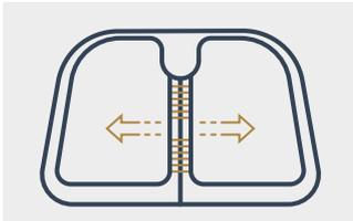
12 Kanäle sorgen für den schnellen Austausch der Luft zwischen den beiden Kammern. Je nach Bedarf kann die Luftmenge mit einem einfachen Knopfdruck an das individuelle Gewicht und die Intensität der Bewegung angepasst werden.
